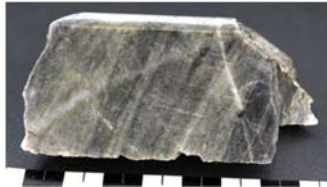
Рис. 1. Образец полосчатого сульфидизированного березита
